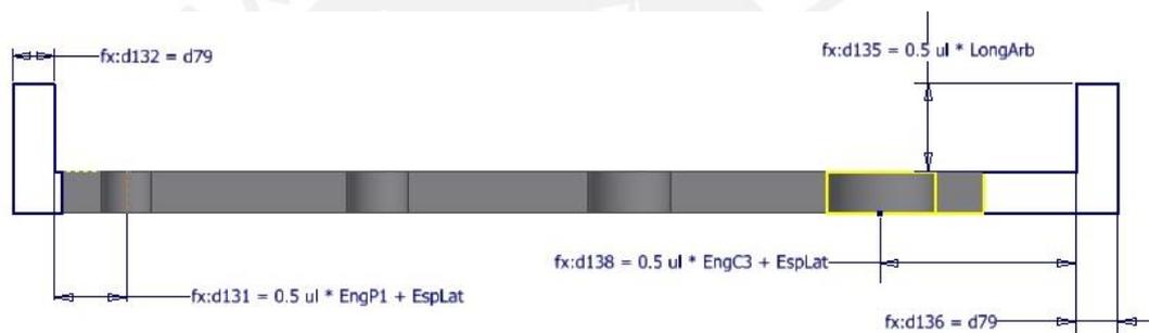
**Fig. 2.3.** Boceto de la plancha de contacto.
