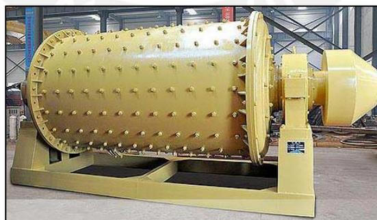
**Fig. 4.4.** Molino de bolas [Fuente: <http://www.trituradora-piedra.com.mx/uploadfile/201209/27/184244941.jpg>]
