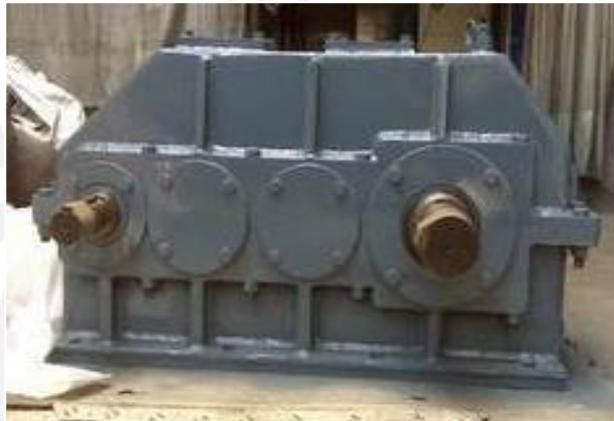
**Fig. 1.11.** Caja reductora con nervio rigidizador simple. [Fuente: <http://solumaq.pe/galeria/equipos-para-mineria>]
