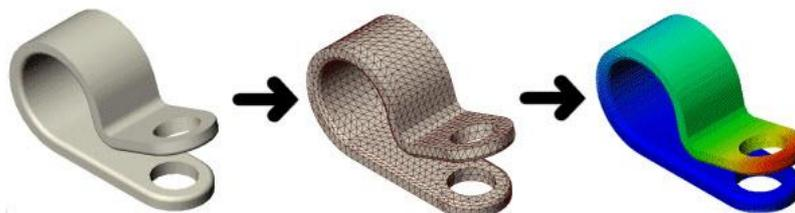
**Fig. 1.19.** Procedimiento seguido en simulaciones numérica: Modelado, Mallado y solución.
