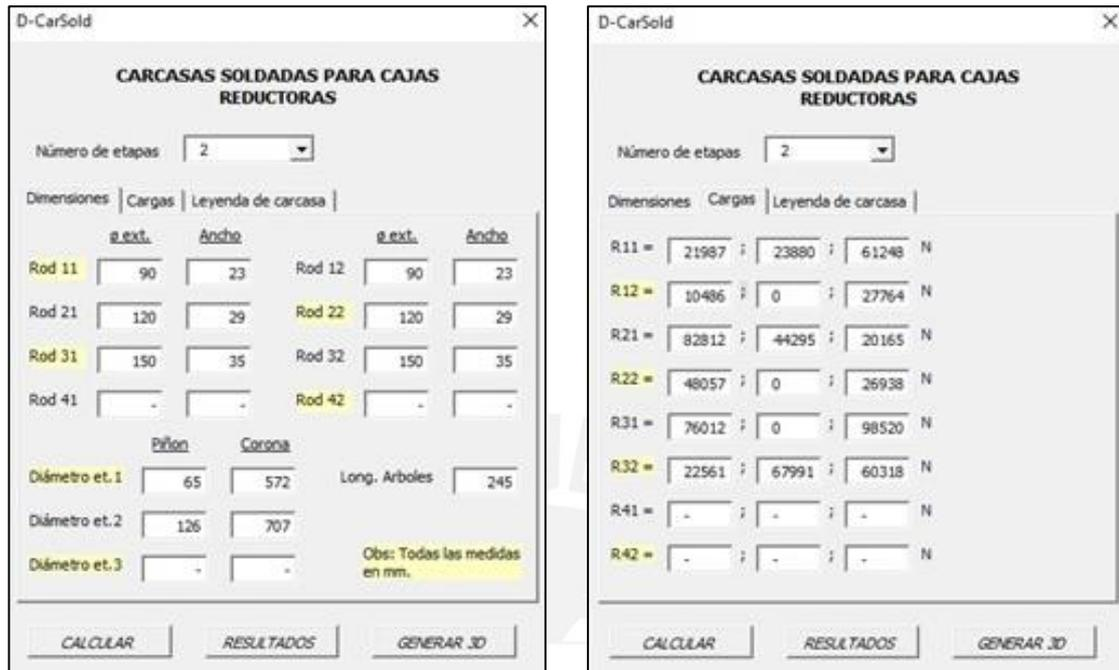
Fig. 4.5. Ventanas para el ingreso de los datos geométricos y de carga.
