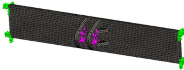
Verificación de resultados El máximo esfuerzo de von Mises para el elemento ocurre en una de las cuñas del soldadas a la plancha posterior. El valor del esfuerzo máximo es de 116 MPa, valor que es 2,15 veces más pequeño que el esfuerzo de fluencia máximo para el acero ASTM A36 por lo cual el elemento no fallará.
