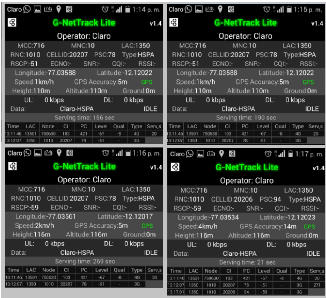
Figura 1.1: Niveles de señal hacia estación Pardo.
