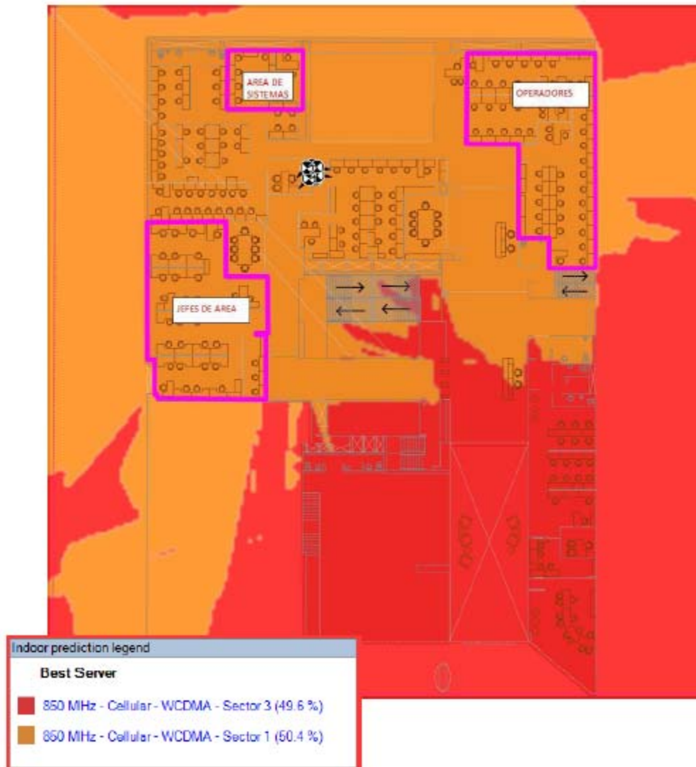
Figura 1.13: Best Server edificio CEM2 Piso 1
