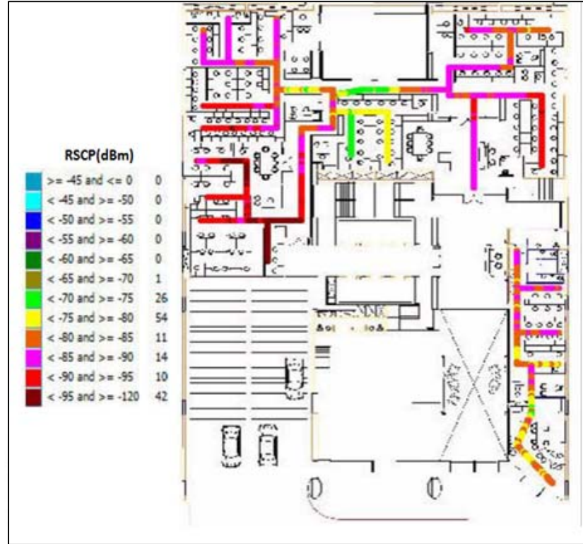
FIGURA 2-20: NIVEL DE RSCP PISO 1 (CEM2)
