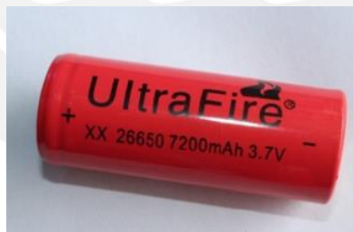
Figura 3. 45. Batería de Litio Recargable Ultrafire de3.7V y 7200mAh [93]
