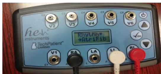
Figura 4. 2. Simulador de señales electrocardiográficas TechPatient de la marca He instruments con los cables conectados según derivación DII [Elaboración propia]
