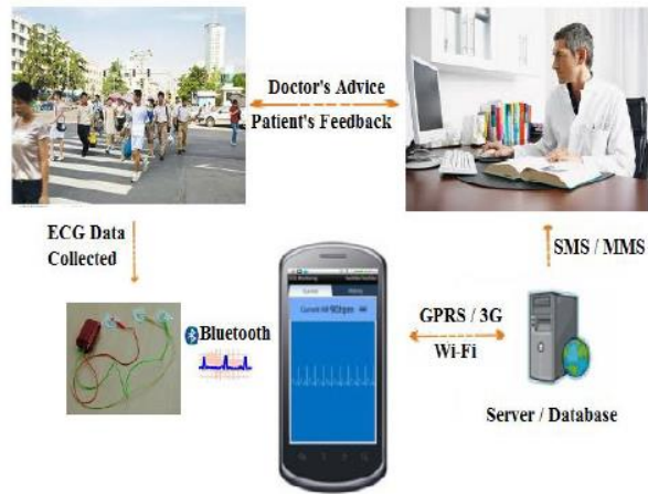
Figura 1. 7. Arquitectura de sistema de detección de arritmias con plataforma celular [37]
