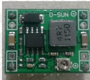
Figura 3. 41. Circuito Convertidor de Voltaje Tipo Buck MOD-MP1584 [Elaboración Propia].
