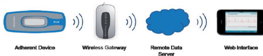
Figura 1. 5. Arquitectura de un dispositivo de detección de arritmias mediante un monitor cardíaco adherente [35]
