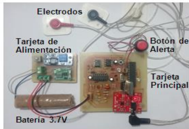
Figura 4. 12. Tarjeta electrónica del sistema implementado [Elaboración propia].
