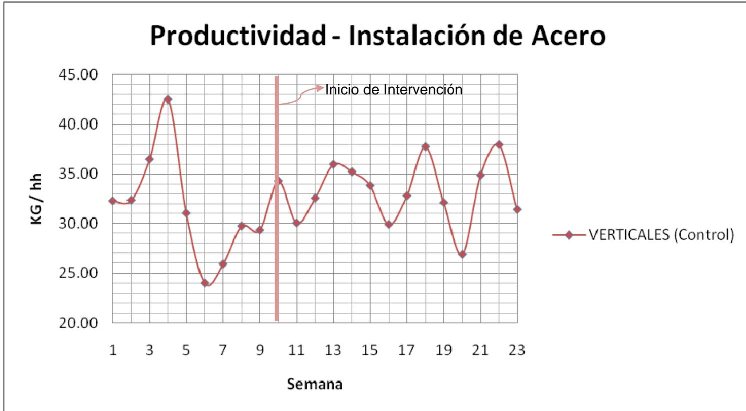
Fig. N° 7. Productividad en instalación de acero en elementos verticales (kg/hh)
