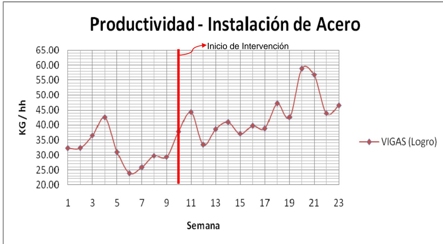
Fig. N° 5. Productividad en instalación de acero en vigas (kg/hh)
