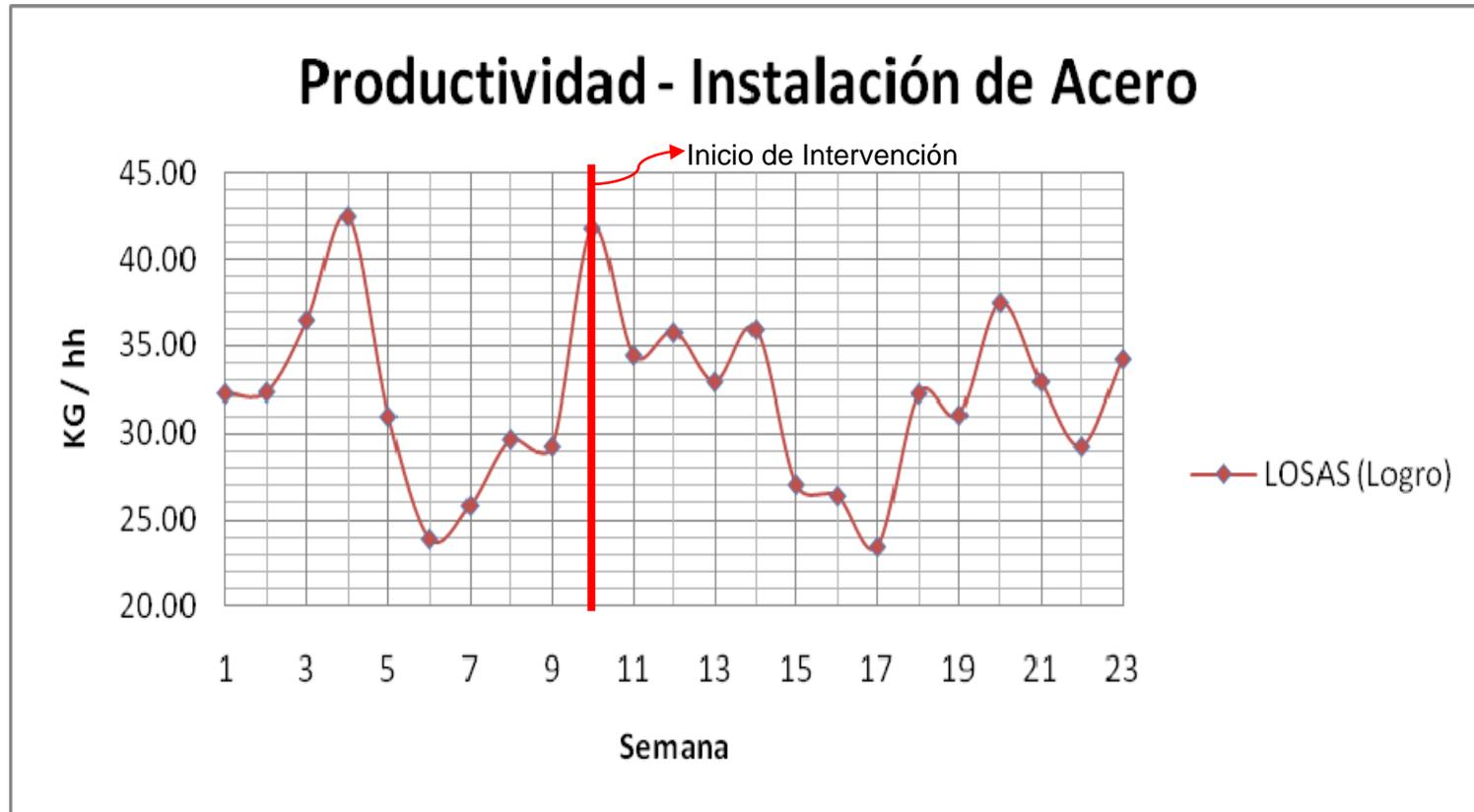
Fig. N° 6. Productividad en instalación de acero en losas (kg/hh)
