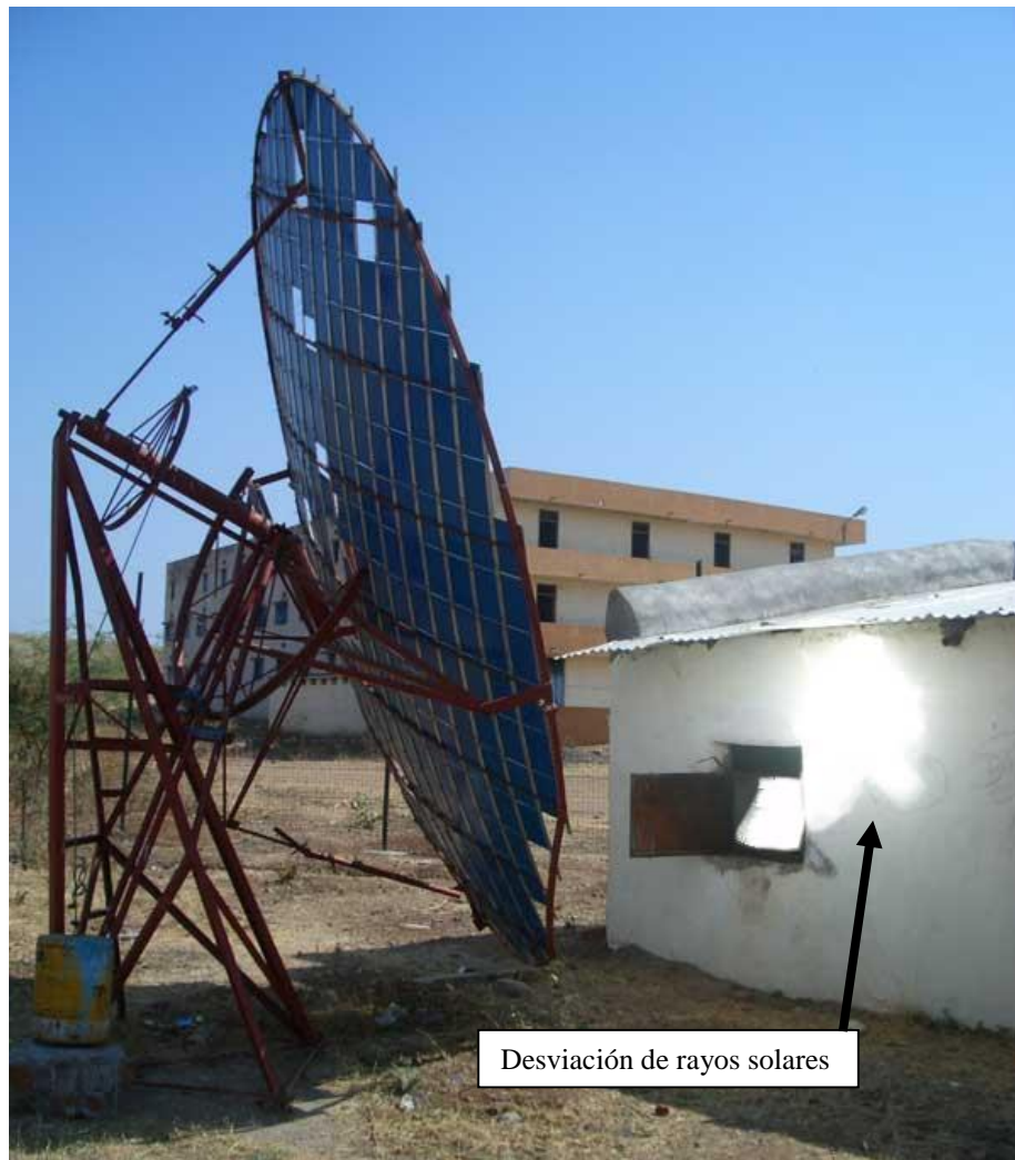
Figura 1.1: Reflector solar Scheffler para una cocina comunitaria. Fuente: Terra.org
