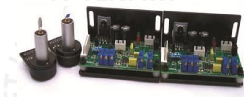
Figura 3.9. Galvanómetro con motores. Fuente: www.lasercentury.com
