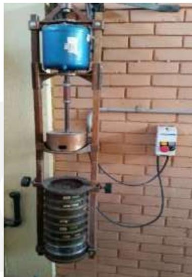
Figura 2.7. Máquina de ensayo para columna de tamices
