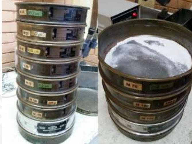
Figura 2.9. Análisis granulométrico de la cal hidratada después de molienda
