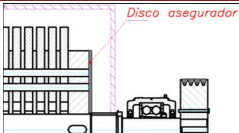
Figura 3.5. Localización del disco asegurador
