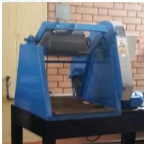
Figura 2.8. Molienda de la muestra de cal
