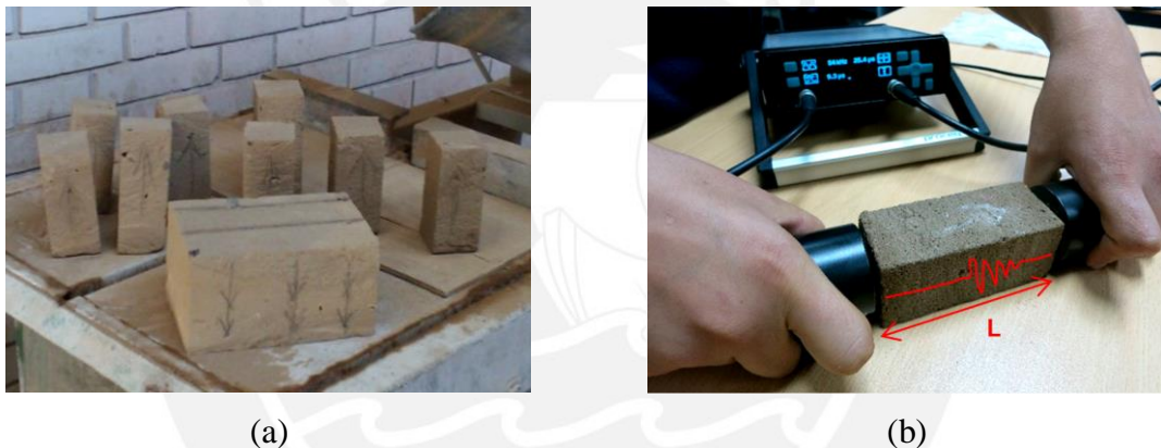
Figura 5.3 Adobe de Huaca de la Luna, ensayos de caracterización ultrasónica: (a) muestras de adobe (b) procedimiento de ensayo de ultrasonido
