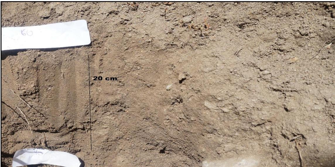
**Figura 29: Determinación de la estructura del suelo** (Propia).
