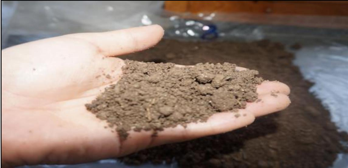
**Figura 28: Determinación de la textura de las muestras de suelos en campo**
