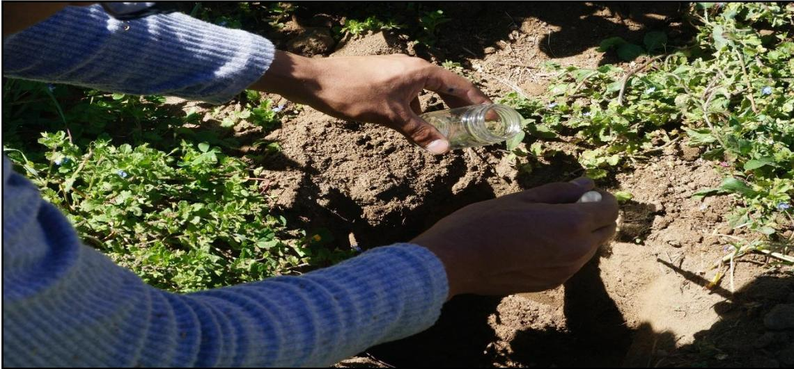
**Figura 31: Estimación de carbonatos en campo (Propia).**
