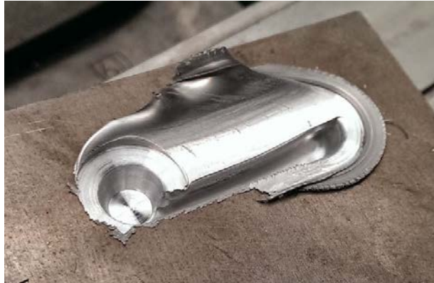
Figura 67. Junta resultante luego de procesar AA5083 usando el pin cónico.
