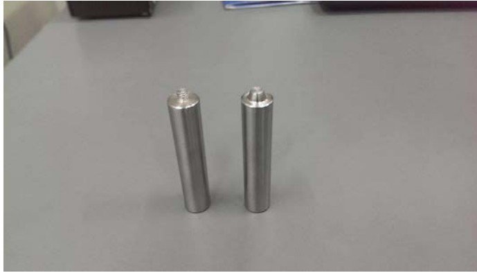
Figura 66. Herramientas usadas en el proceso de fricción batido (pin cilíndrico roscado y pin cónico).
