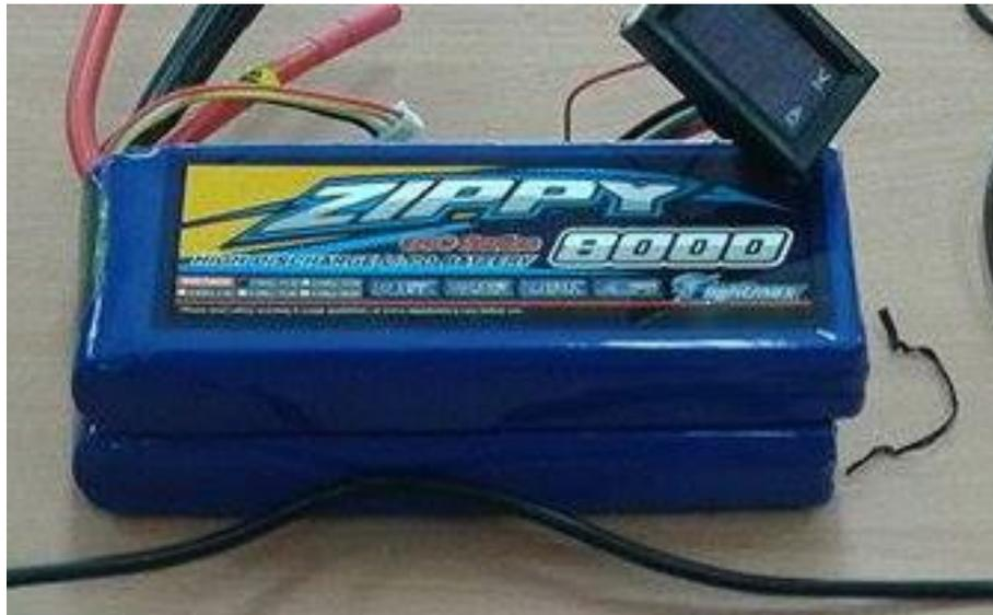
**Figura 3.16:** Batería seleccionada (Batería LiPo 8000mA/h - 3 celdas)
