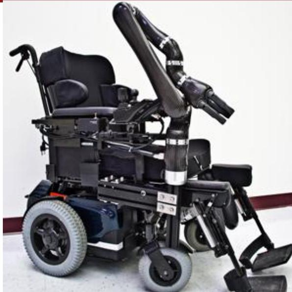
**Figura 2.2:** Brazo robótico Mico de la marca *Kinova* montado en una silla de ruedas
