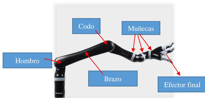
**Figura 3.11:** Brazo Jaco de Kinova y sus partes [39]
