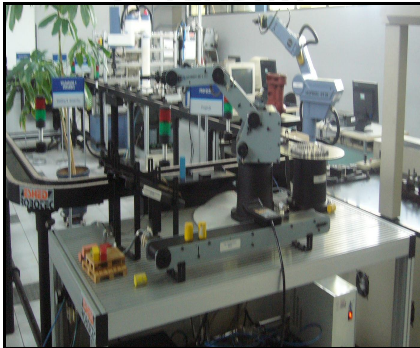
Figura 4.6. Sistema usado en la simulación del control del artroscopio
