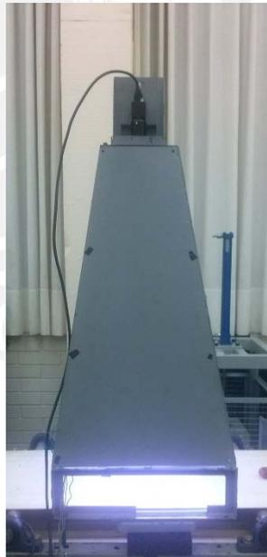
Figura 4.8 Montaje final de la cámara con el sistema de iluminación
