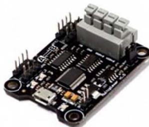
*Figura 2.13 Conversor Serial seleccionado*
