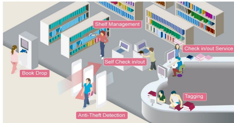
Figura 13. Sistema RFID en biblioteca y sus componentes.
