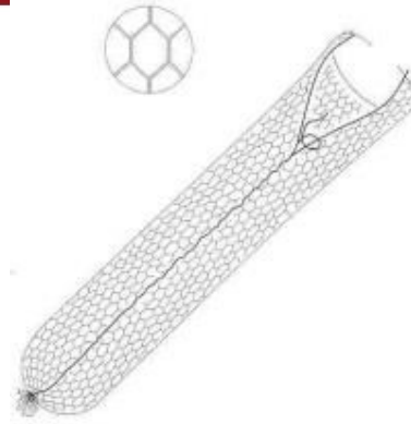
Figura 2-2: Gavión tipo saco (Maccaferri, 2008).
