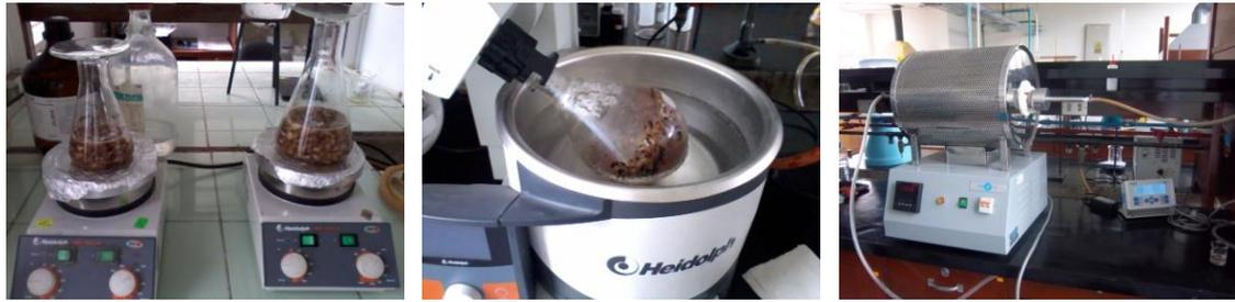
**Figura 14.** Etapas de la preparación del carbón activado a partir de semilla de aguaje. Impregnación (izquierda y centro) y activación térmica (derecha).
