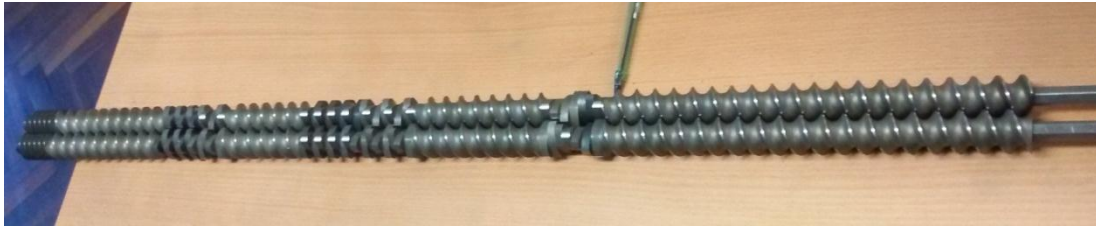
Figura 2.6: Configuración del tornillo de extrusión para la fabricación de los filamentos.
