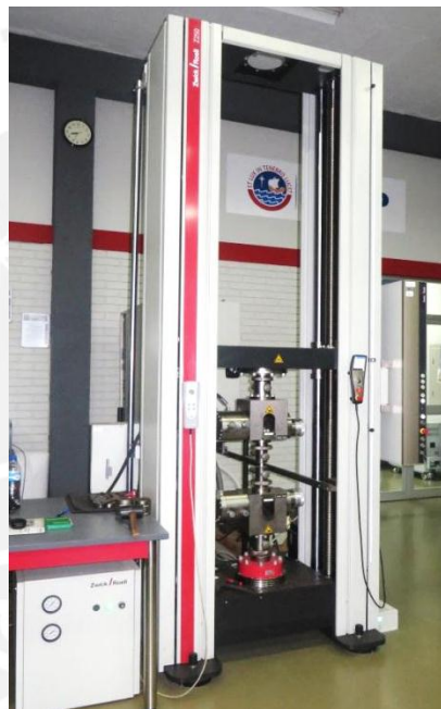
Figura 2.18: Equipo de ensayo universal Zwick Roell Z250
