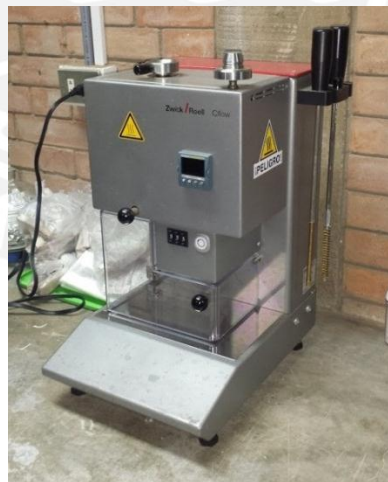
Figura 2.19: Equipo para medición del índice de fluidez Zwick Roell BMF-003
