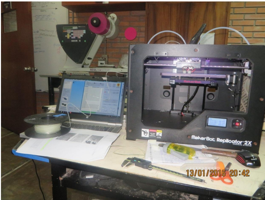
Figura 2.23: Fabricación de probetas utilizando mezclas poliméricas (carrete) empleando la técnica de modelado por deposición de fundido
