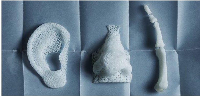
Figura 1.7: Diferentes partes modeladas y fabricadas por FDM [De Ciurana, 2013]
