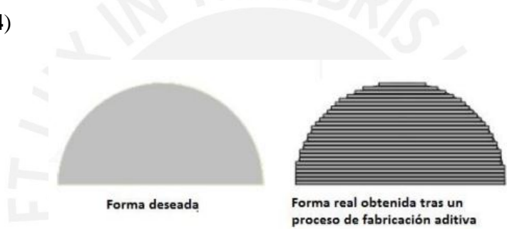
Figura 1.4: Diferencia entre el modelo y la fabricación aditiva por capas (Relaño,2013)
