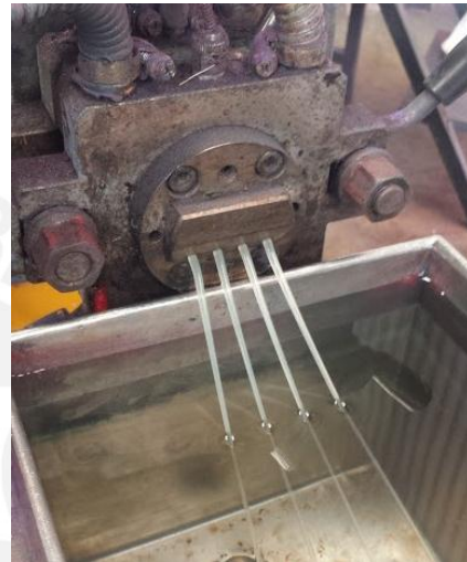
Figura 2.8: Dado extrusor de cuatro salidas. Para procesar múltiples filamentos a la vez.
