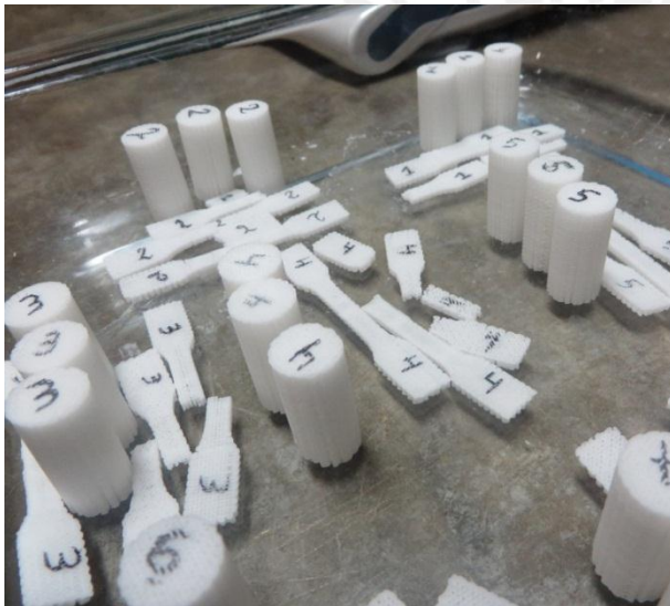
Figura 3.41: Probetas de PLA fracturándose de manera frágil.
