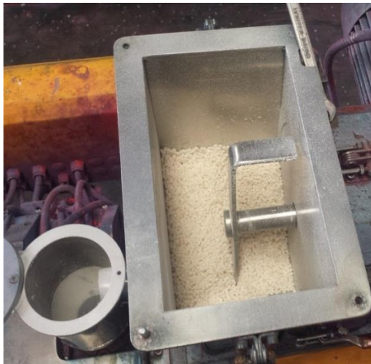
Figura 2.6: Configuración del tornillo de extrusión para la fabricación de los filamentos.
