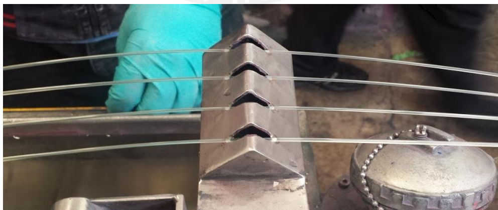
Figura 2.9: Filamento extruido al cual se extrae la humedad por medio de unas boquillas de succión.
