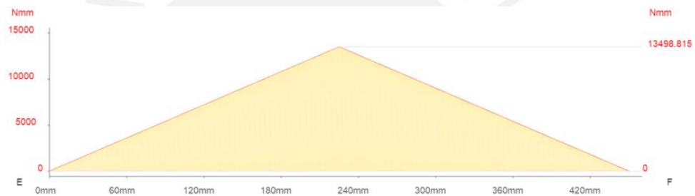
Figura 39. Diagrama de momentos flectores del elemento E-F. Fuente: Propia.
