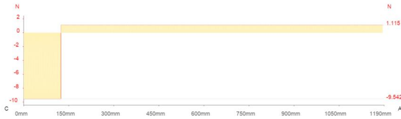
Figura 26. Diagrama de fuerzas cortantes de la columna C-A. Fuente: Propia
