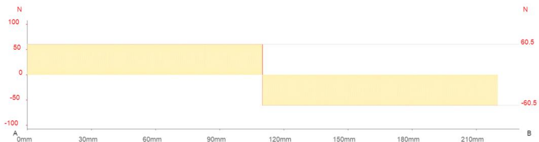
Figura 17. Diagrama de fuerzas cortante de la viga más crítica: Fuente: Propia.
