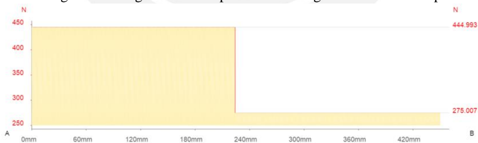
Figura 23. Diagrama de fuerza cortantes de la viga A-B. Fuente: Propia.
