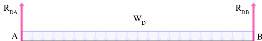
Figura 41. Diagrama de cuerpo libre de la placa depósito. Fuente: Propia.
