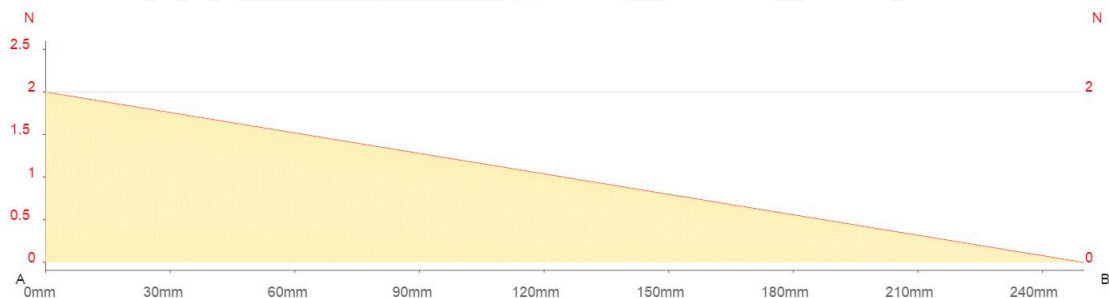
Figura 3. Diagrama de fuerzas cortantes de las placas de las paredes giratorias de la cámara. Fuente: Propia.
