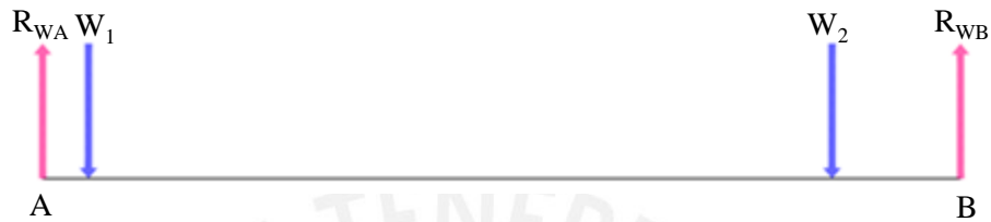
Figura 13. Diagrama cuerpo libre de la placa soporte del módulo de medición y manipulación y tolva. Fuente: Propia.
