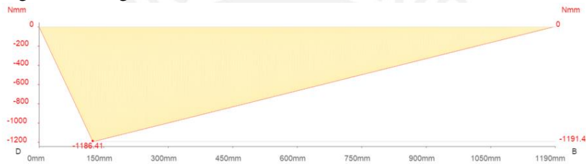
Figura 27. Diagrama de momentos flectores de la columna C-A. Fuente: Propia.
