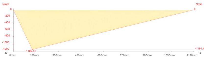
Figura 30. Diagrama de momentos flectores del elemento D-B. Fuente: Propia.
