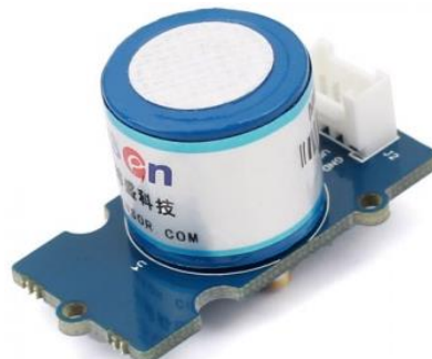
Figura 4.13: Sensor de oxígeno Winsensor ME3. Fuente: http://www.winsensor.com/
