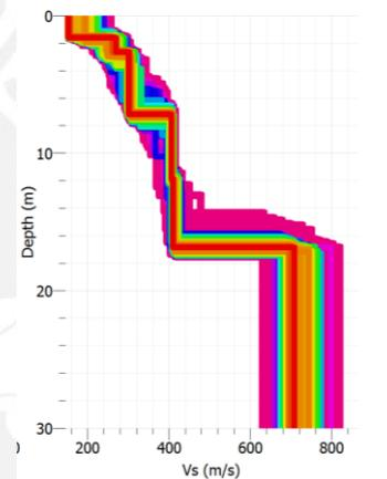
(c) Perfil velocidad de onda de corte
