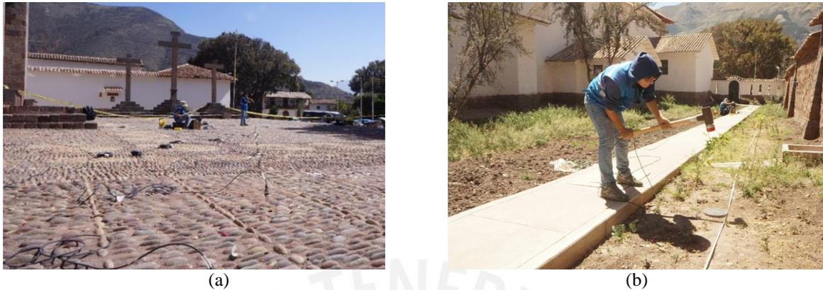
**Figura 4.6:** Ensayos MASW en (a) el frontis y (b) en el lateral Este de la Iglesia
