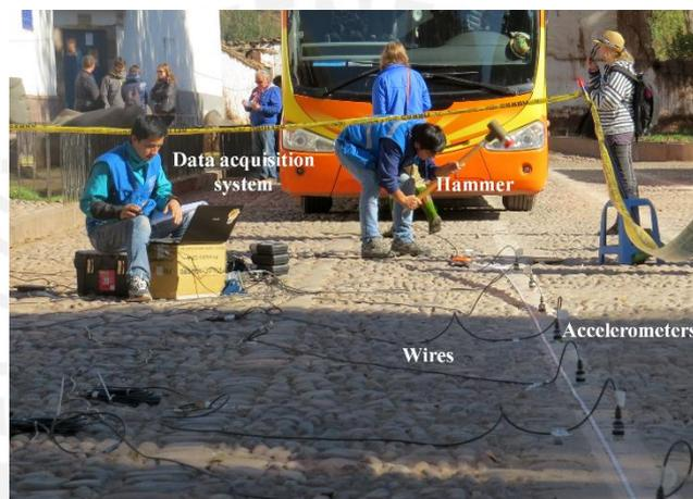
**Figura 2.22:** Configuración de los equipos realizada en campo para el ensayo MASW
