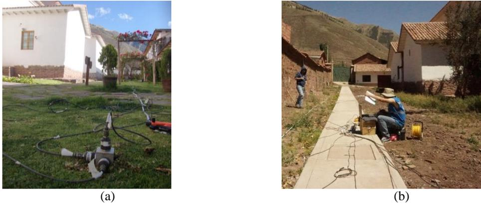
**Figura 4.8:** Ensayo del cociente espectral realizado en el (a) lado lateral este y (b) lado lateral oeste de la Iglesia.
