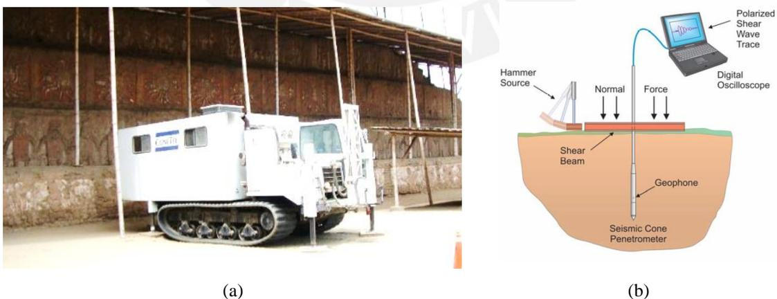
**Figura 3.13:** (a) Camión oruga SCPTu e (b) Ilustración del sistema SCPTu
