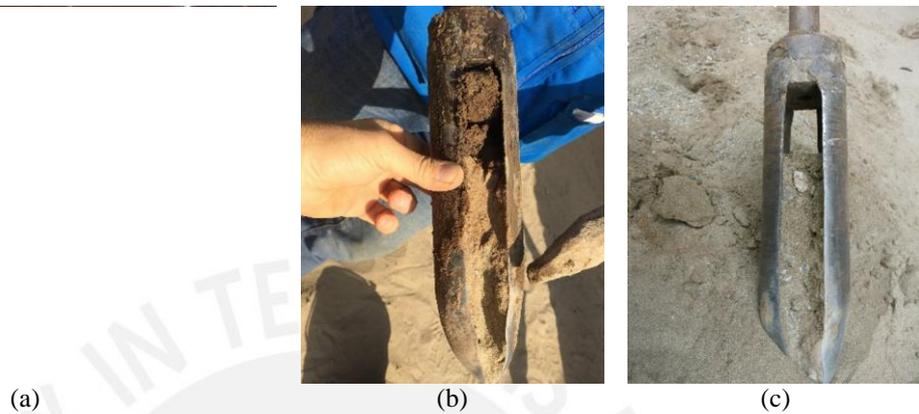
**Figura 3.16:** (a) Muestreo con barreno manual en la fachada norte (B-1) se encuentra en el primer estrato (b) arena medianamente densa, seguido por una capa de (c) arena gravosa a partir de los 3 m aproximadamente.
