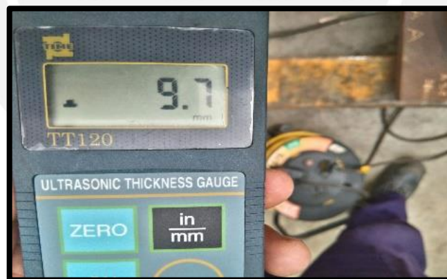
Figura 3.9 - Medición de espesores antes del dañado
