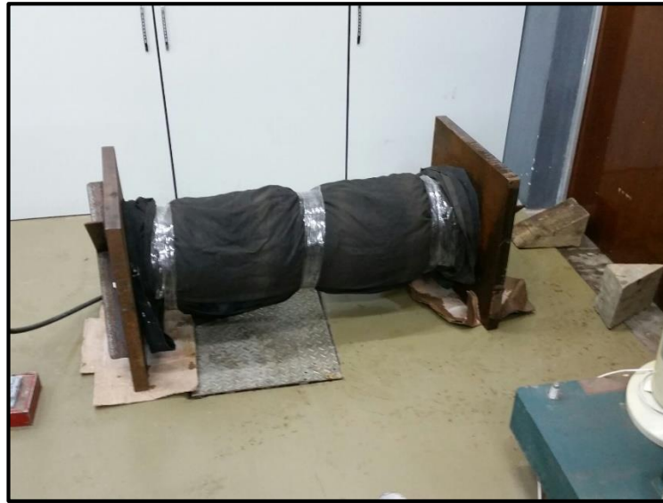
Figura 4.1 - Tubería a ensayar hidrostáticamente
