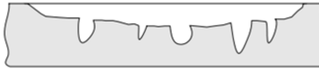
Fig. 2.4 Picadura localizada dentro de un área local delgada. [4]
