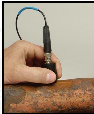
Fig. 1.23 Medición de corrosión por ultrasonido
