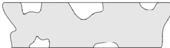
Fig. 2.5 Daño por picadura en ambas superficies de una pared sin superponerse. [4]
