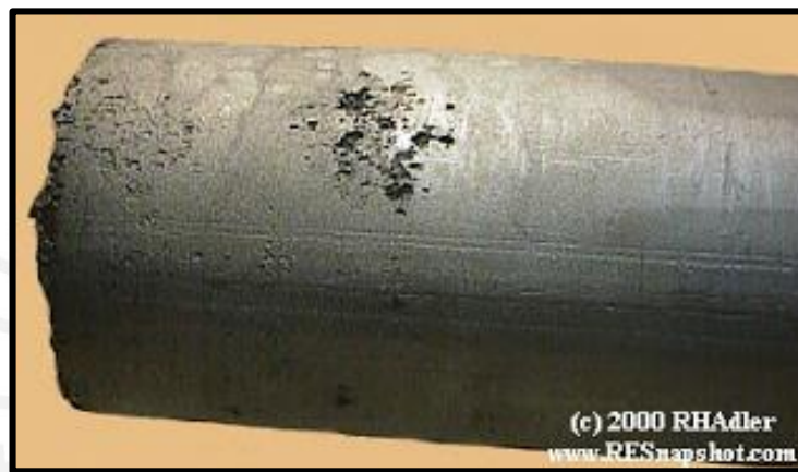
Fig. 2.1 Corrosión por picadura en la superficie externa. [13]
