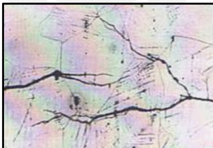
Fig. 1.6 Detalle de grieta transgranular originada por corrosión bajo tensión en acero inoxidable austenítico. [16]
