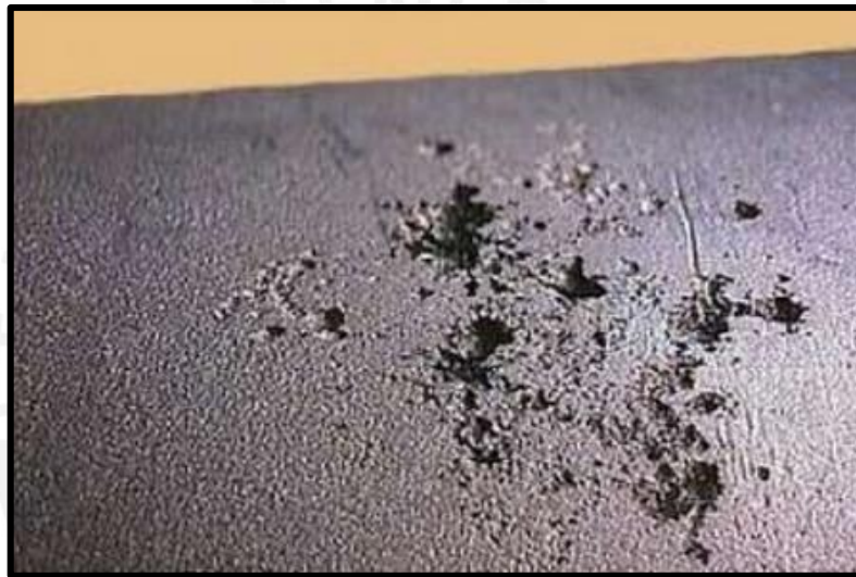
Fig. 1.4 Corrosión por picadura. [14]
