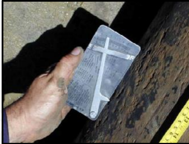
Fig. 1.20 Ejemplo de medición de picaduras. [4]
