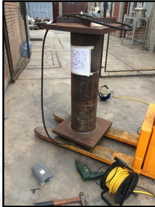
Fig.3.2 Preparación de la tubería para realizar daño
