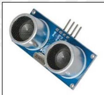
*Figura 3.19. Sensor de proximidad o distancia. Fuente: Adafruit*
