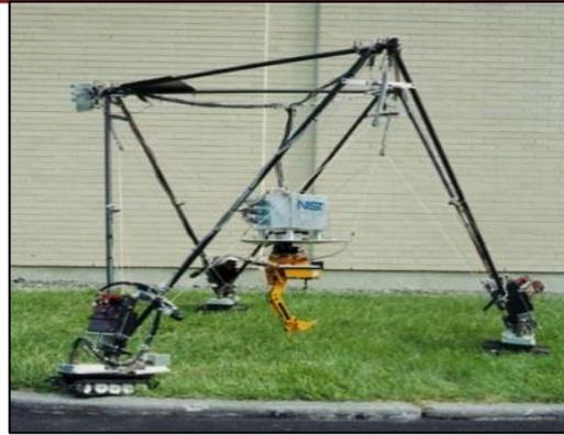
*Figura 1.2 Prototipo del RoboCrane*
