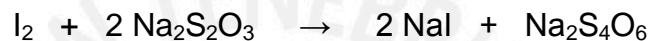
Figura 12. Reacciones involucradas en la determinación de índice de peróxidos en un aceite, según el método iodométrico. Fuente Miller 2001.
