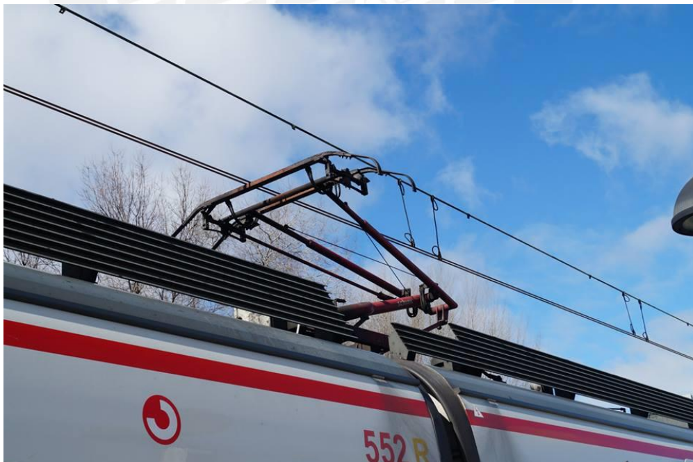
Contacto pantógrafo catenaria, Cercanías Madrid
