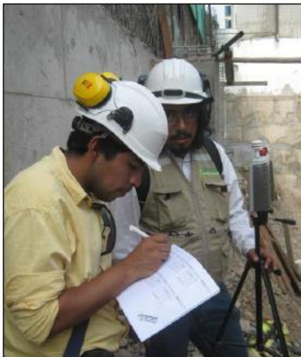
**Comentario:** En este caso, el equipo de medición se ubicó en una zona cercana a los trabajos de excavación, a una distancia que permita realizar las mediciones de manera adecuada y lo suficientemente distante como para no sufrir accidentes y no perturbar los trabajos en ejecución.
