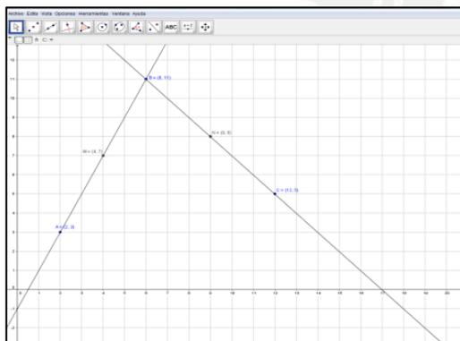
**Paso 4:** Traza la mediatriz de AB y de BC. Utilizando la herramienta
