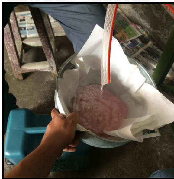
Figura 3. 5 – Filtrado de la gasolina pura.
