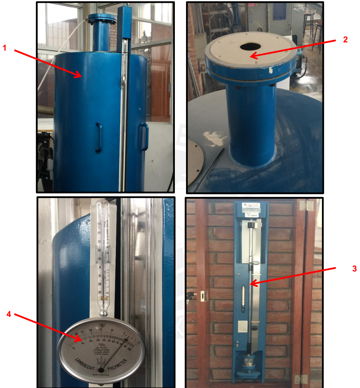
Figura 3. 14 – Conjunto de equipos de medición del aire húmedo y seco admitido al motor.
