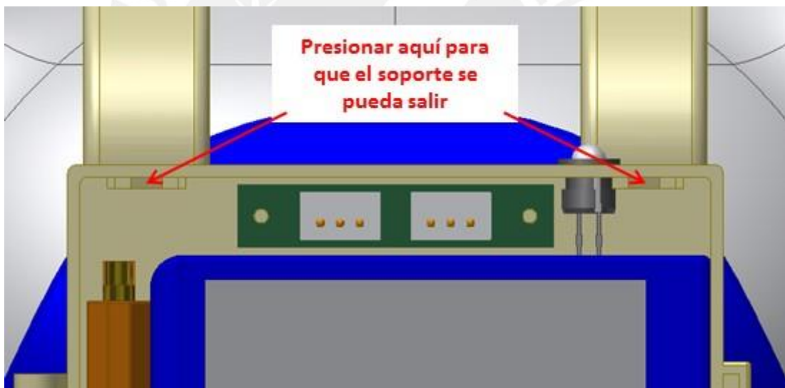
Figura 2. 283: Tercera parte del módulo, sujeción. (Fuente: Propia)
