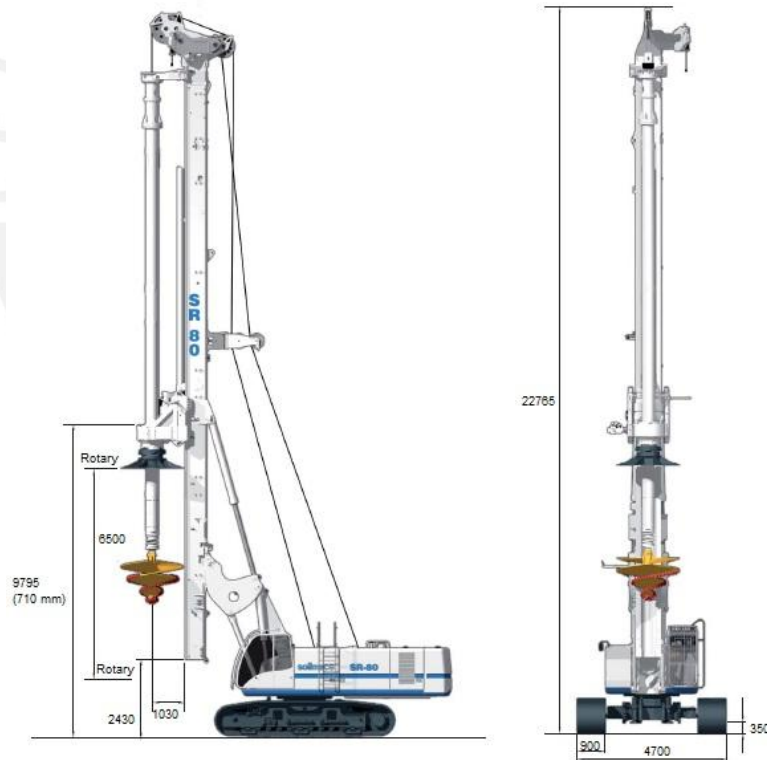
Fig. 4.15 – Máquina pilotera SOILMEC SR80 (SOILMEC, 2015)
