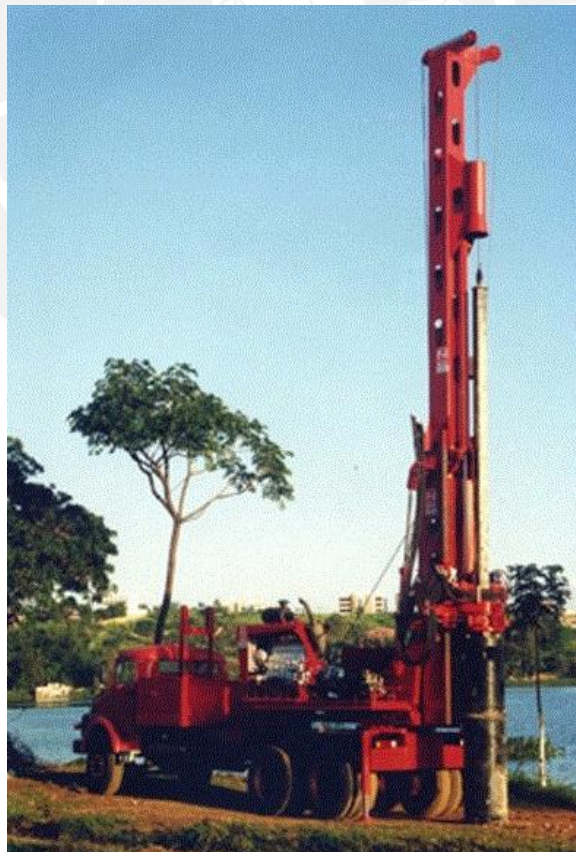
Fig. 4.10 – Equipo Franki tipo XXIX (Pilotes Franki Peruana, 2015)
