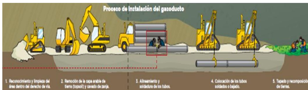
Figura 1.5 Proceso de instalación del gasoducto [11].
