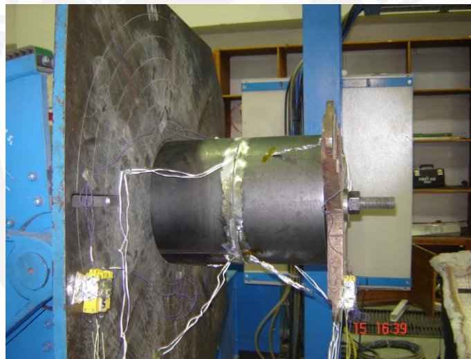
Figura 3.35. Arreglo general utilizado en trabajo de Qureshi para medición de temperaturas, tensiones y deformaciones residuales [22].
