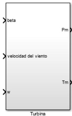
Fig. 2.6 Modelo de Turbina desarrollado en Simulink
