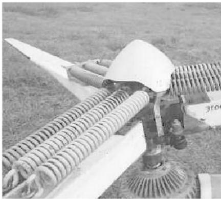
Fig 1.14 Sistema mecánico de Control de ángulo de paso (Wind Power Basics 2010 )
