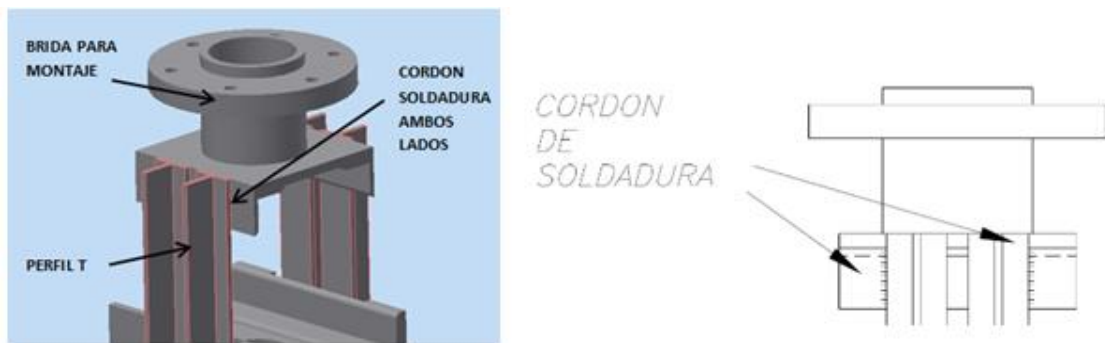
Figura 78: Vista de la soldadura de la estructura
