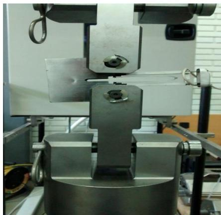
Fig. A5. Conexión de equipamientos para ensayos de rotura
