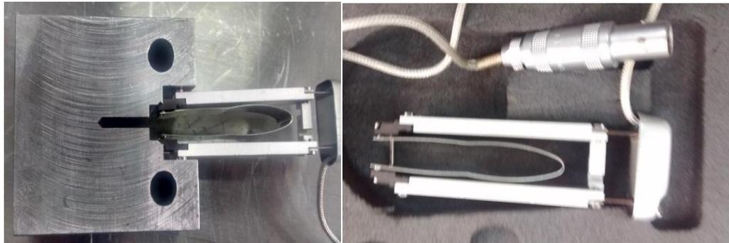
Fig.A2. Galga de desplazamiento
