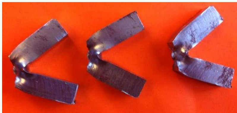
Figura 3.26. Deformación final de las probetas de ensayo de impacto Charpy
