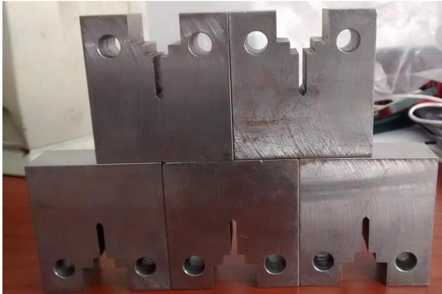
Figura 2.5: Segunda etapa, electroerosión de Muesca
