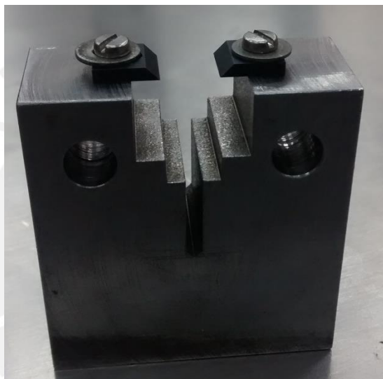
Figura 3.3 Probeta CTOD con galgas de medición de apertura de boca
