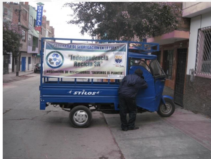
Fotografía N° 3. Motocar de una capacidad de 2\text{m}^3
