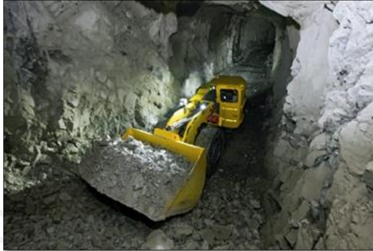
Figura 17: Equipo de limpieza – CAT R1600G
