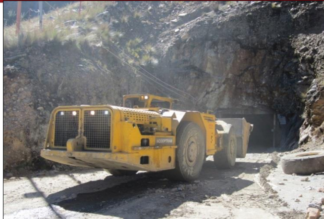
Figura 19: Equipo de limpieza – CAT R1600G
