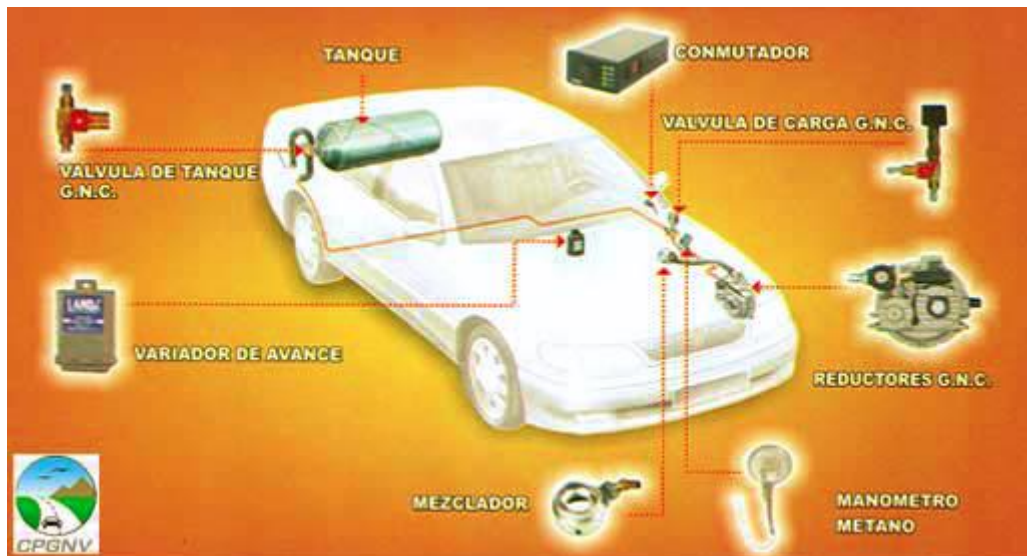
Gráfico 3: Modo de Conversión del Automóvil Fuente: Cámara Peruana de Gas Natural Vehicular
