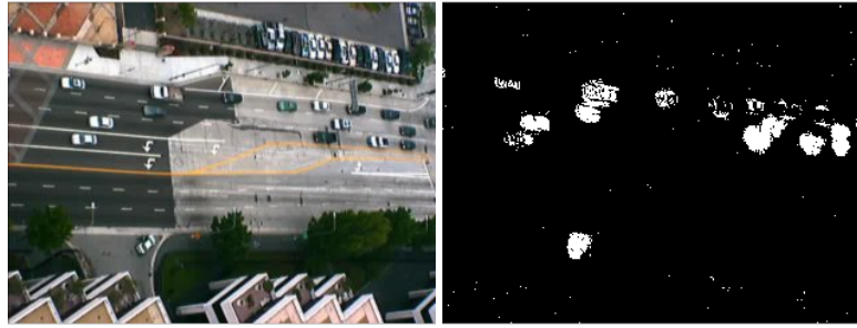
Figura 2.3: (a) Cuadro de una secuencia de tránsito (b) Segmentación resultante de aplicar mixtura de gaussianos
