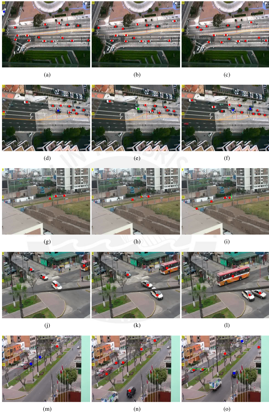
Figura 4.2: Secuencias correspondientes a (a)..(c) Lankershim 1, (d)..(f) Lankershim 3, (g)..(i) Pabellón A, (j)..(l) San Martín 1, y (m)..(o) San Martín 2. Se señala con un círculo rojo aquellos objetos que el algoritmo interpreta como 1 vehículo, con un círculo azul aquellos que son interpretados como 2 vehículos, y con uno verde aquellos que son interpretados como 3 vehículos.
