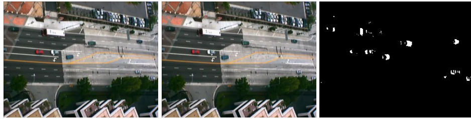
Figura 2.1: (a),(b) Cuadros consecutivos de tránsito vehicular, en los cuales los vehículos de la derecha están en movimiento y los de la izquierda están detenidos en el semáforo (c) Segmentación resultante de aplicar diferenciación temporal
