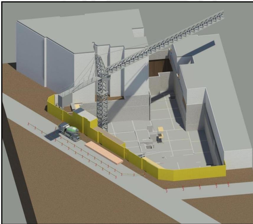
**Fig. 13** *Layout dinámico en etapa de vaciado de techo de sótanos.
