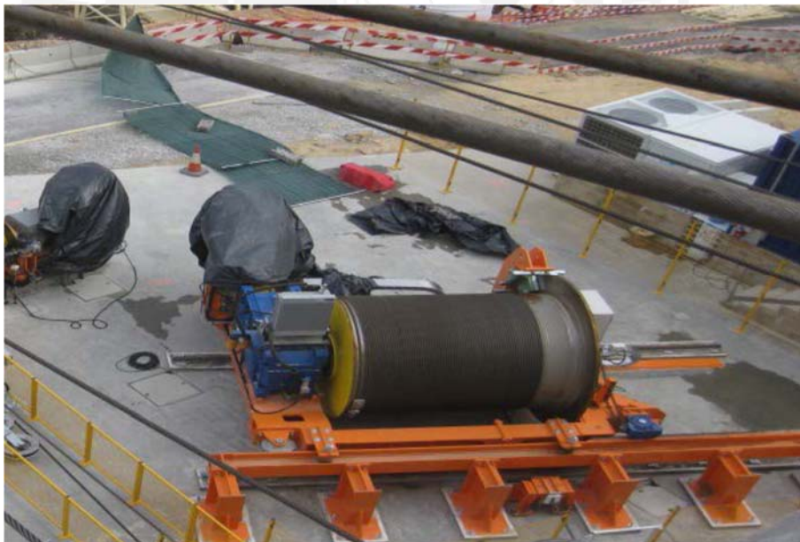
Foto 3.05. Cabrestante de levantamiento (Fuente CRM-CHCDA).
