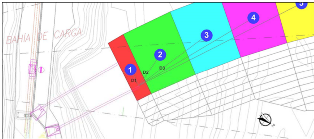
Fig 5.20. Esquema de distancias a recorrer para vaciados con el camión volquete y “mixer”. (Fuente propia)
