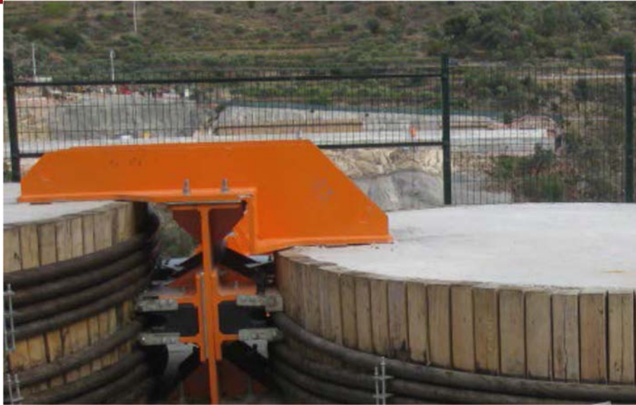
Foto 3.12. Zapatas fijas (Fuente propia).
