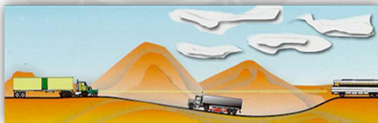
Figura 2.8: Alineamiento vertical Peligroso.
