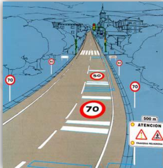
Figura 2.9: Diseño de tramo vial señalizado,
