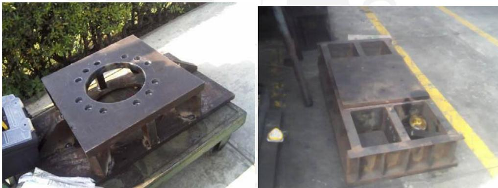
Fig. 4.3 Izquierda: Foto de la brida del cilindro hidráulico fabricada. Derecha: Foto de la mesa superior en fabricación.
