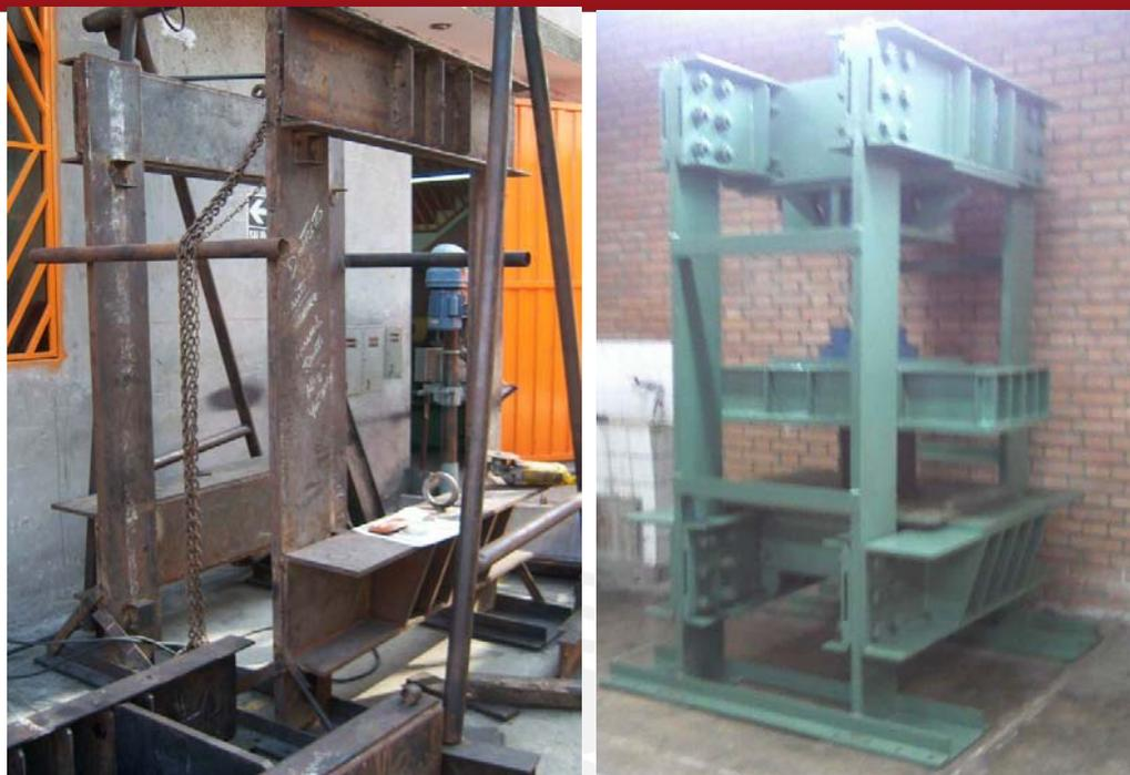
Fig. 4.4 Izquierda: Foto de la fabricación de los pórticos. Se observan arriostres para reducir las deformaciones por soldadura. Derecha: Foto de la prensa hidráulica instalada en el Laboratorio de Fundición (PUCP).
