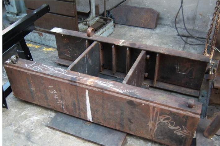
Fig. 4.2 Foto de la fabricación de las vigas superiores y el soporte superior.
