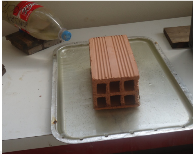
Fig. N° 7: Ensayo de succión de unidades tubulares.
