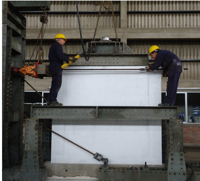
Fig. N° 41: Preparación y equipamiento del muro para el ensayo.
