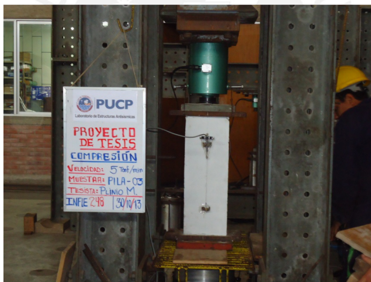
Fig. N° 13: Instalación de pila de albañilería para ensayo de compresión.
