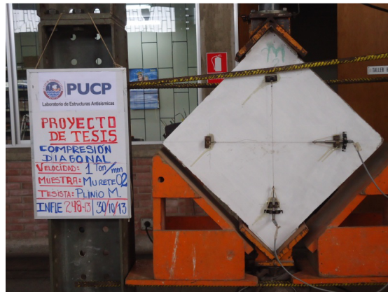
Fig. N° 22: Instalación del murete para el ensayo.
