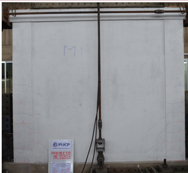
Fig. N° 45: Fisuras horizontales en las columnas y fisuras diagonales en la albañilería – Fase 03 (MR-01).
