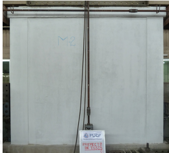
Fig. N° 51: Comportamiento Elástico sin presencia de fisuras – Fase 01 (MR-02).
