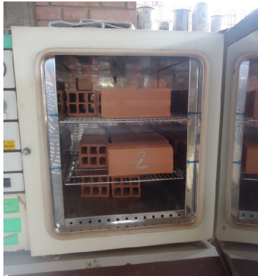
Fig. N° 8: Ensayo de absorción: Unidades en el horno.
