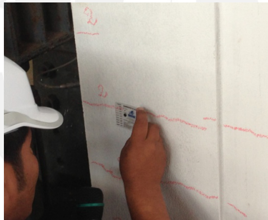
Fig. N° 44: Medición de magnitud de la fisura – Fase 02 (MR-01).
