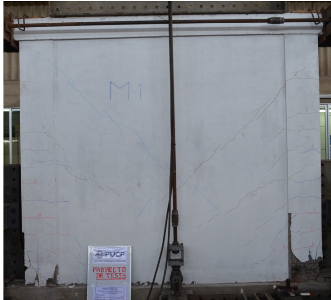
Fig. N° 48: Trituración de columnas en los talones (vista panorámica) – Fase 06 (MR-01).
