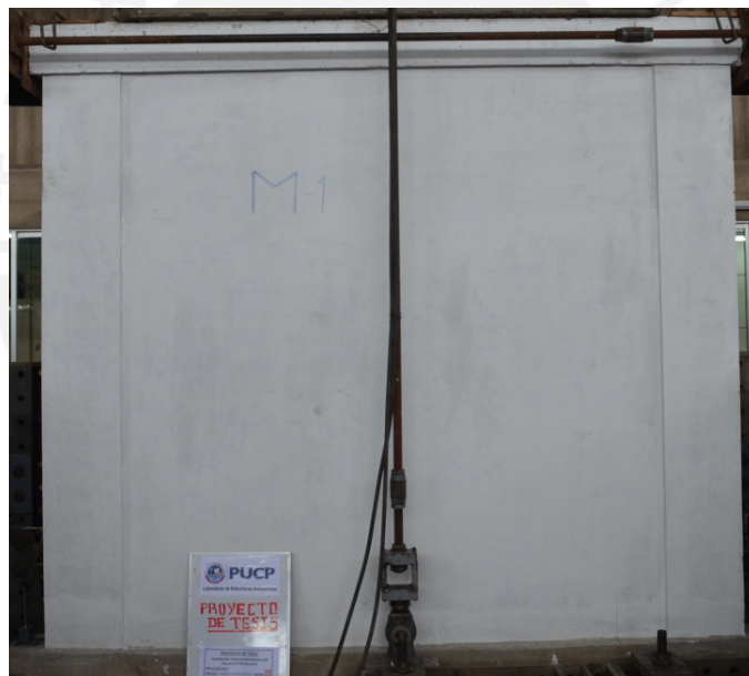
Fig. N° 42: Comportamiento Elástico sin presencia de fisuras – Fase 01 (MR-01).
