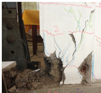
Fig. N° 56: Talón de columna triturado.
