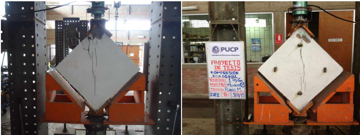
Fig. N° 23: Forma de falla de los muretes N°02 y N°03.
