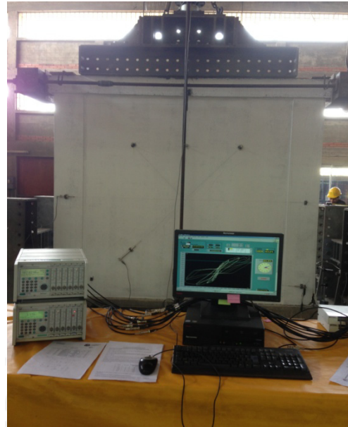
Fig. N° 39: Ubicación de los LVDT's en los muros MR-01 y MR-02.
