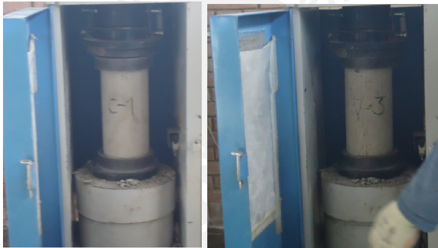
Fig. N° 9: Ensayo de Compresión de probetas de concreto: Columnas y Vigas de Confinamiento.
