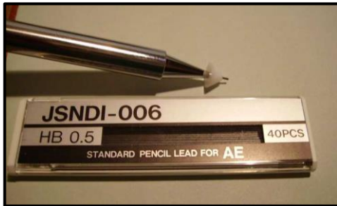
Figura 2.30 Punta de Lápiz con teflón [2]
