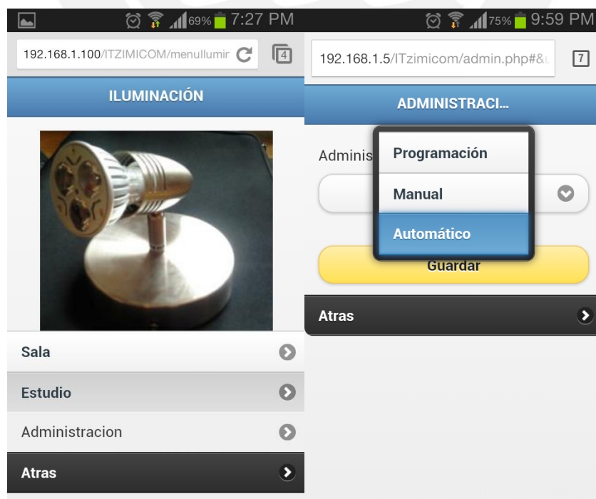
Figura 20 y 21: Menú secundario y selección del modo de operación
