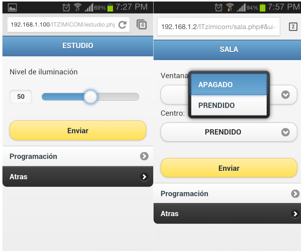
Figura 22 y 23: Interfaz del control en tiempo real del estudio y de la sala.
