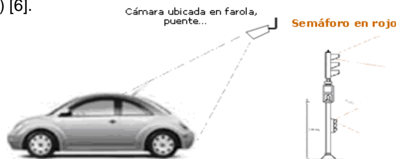
Figura 1.6 Ejemplo de Sistema de monitoreo de infracciones de tránsito. La cámara reconoce la placa del vehículo al pasar la luz roja.
